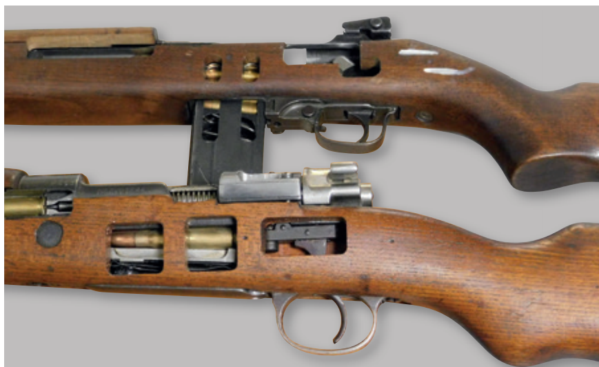
En haut : Carabine USM1 didactique dont on voit le chargeur évidé. En bas : Mauser 1898 dont on voit le système de détente, la planchette élévatrice avec une munition et une munition chargée avec le percuteur en face. La culasse a également été évidée pour dévoiler son ressort.
