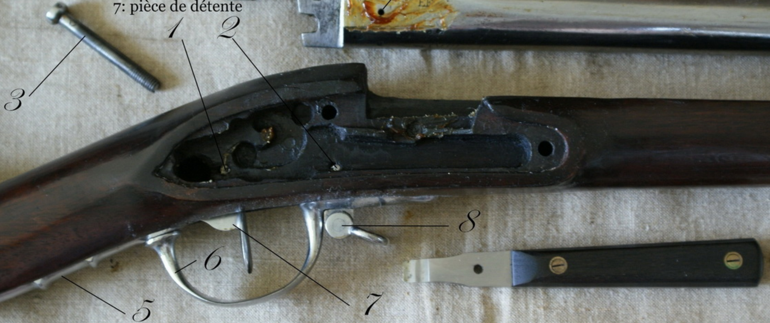
Fusil de munitions 1777 c an 9 - canon démonté, logement de la platine, vue des axes de détente & battant de sous garde.
